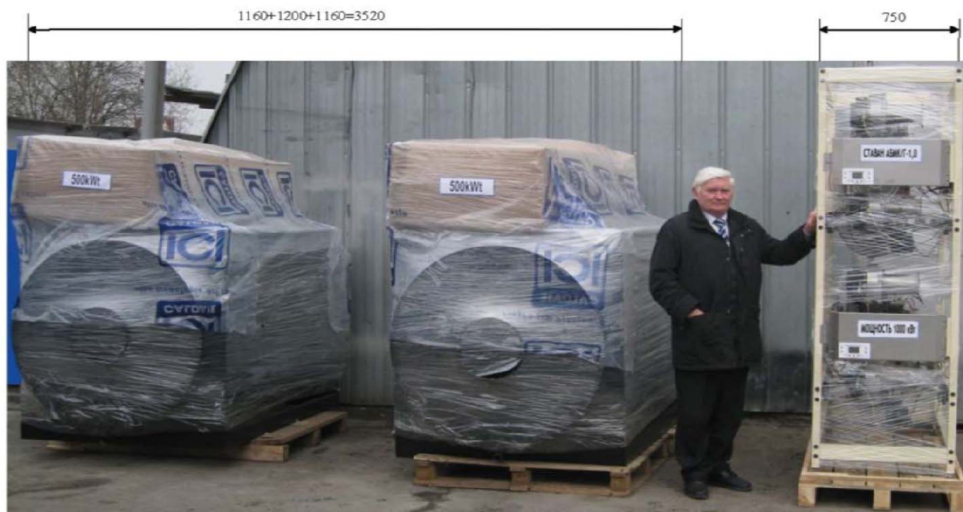
Сравнительные габаритные размеры двух стандартных котлов 2х500кВт и одного котлоагрегата «Ставан - АБМК» 1000кВт
