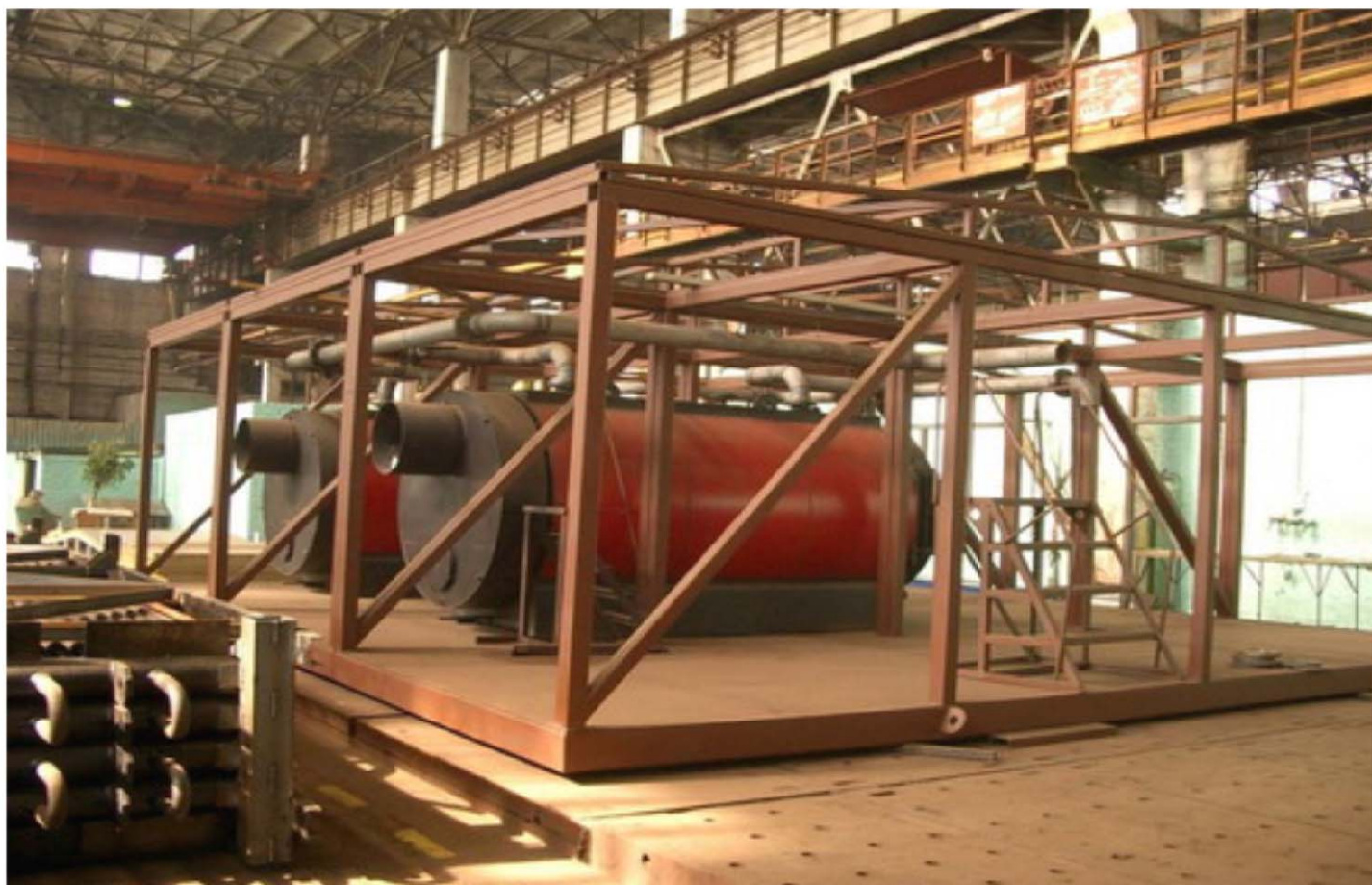
Изготовление БМТК мощностью 6 МВт
